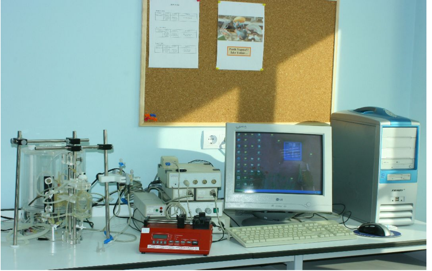
Resim 2. Kayıt işlemlerinin yapıldığı Data Acquisition Sistemi (Powerlab/8SP)
