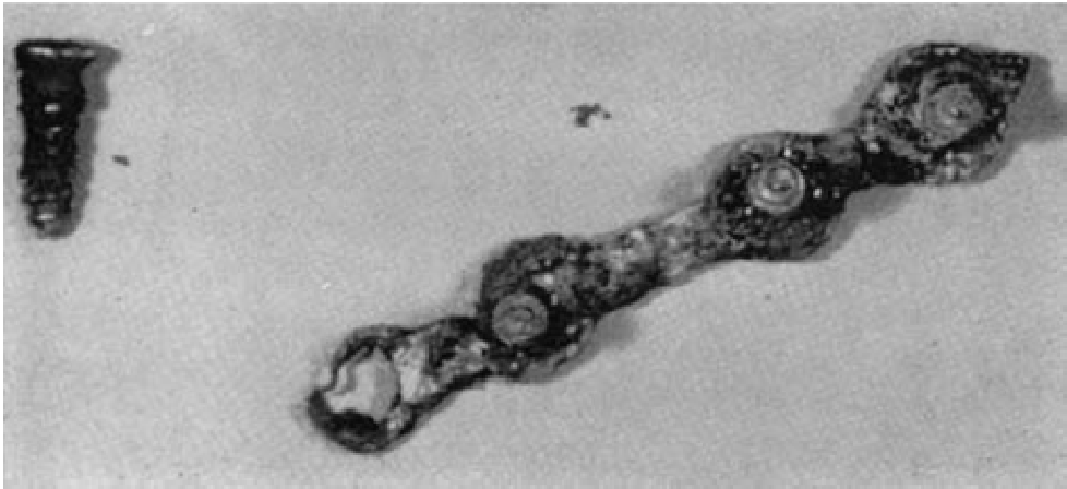
Şekil 1: Lane'in plağı korozyondan dolayı kullanımdan çekilmiştir (1895 ) (1).
