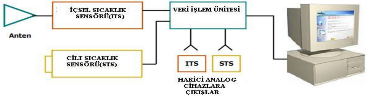
Şekil 12: RTM-01-RES Sisteminin Fonksiyonel Şeması
