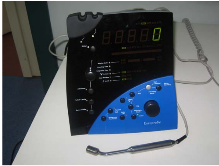
Şekil 6: Gama prob; dedektör ve kayıt ünitesi.
