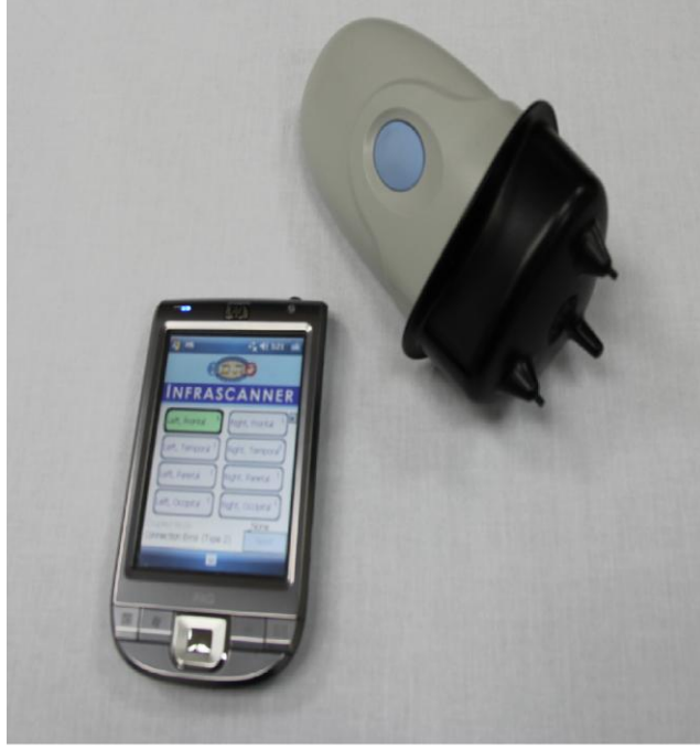
Şekil 7. Infrascanner™ Model 1000 Taşınabilir Yakın-Kızılötesi Görüntüleme Cihazı(PDA ve dedektör)
