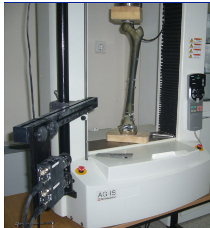
Şekil 9 : Bir örneğin aksiyel yüklenme testi ve video ekstansiyometre cihazı
