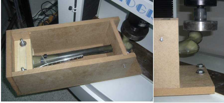
Şekil 14 :Bir örneğin rotasyonel yüklenme testi ve platformun görünümü
