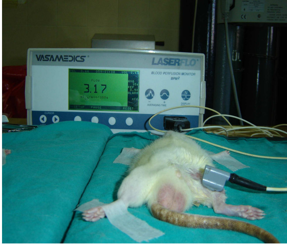
Şekil 4. Ratta İÖK öncesi bacak akımının lazer akımölçerle gösterilmesi
