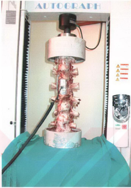
Resim 3. Omurga modeli, basma aleti ve yük hücresinden oluşan tüm sistemin görünümü
