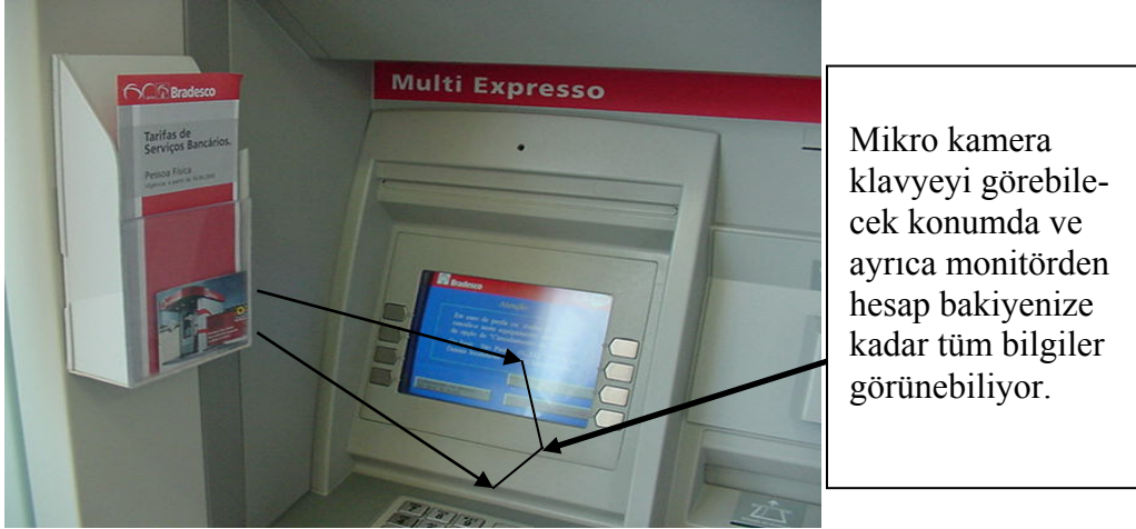
Şekil 143: ATM Makinesindeki Gizli Kameranın Görüş Alanı
