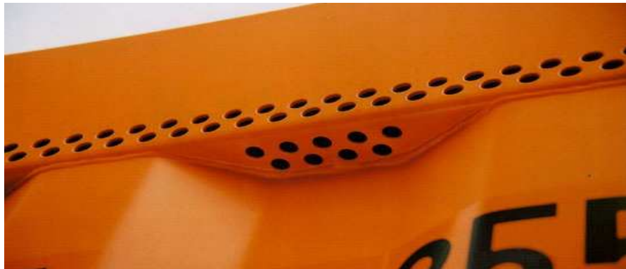
Şekil 2.7: Havalandırılmalı Konteynerin Havalandırma Delikleri
