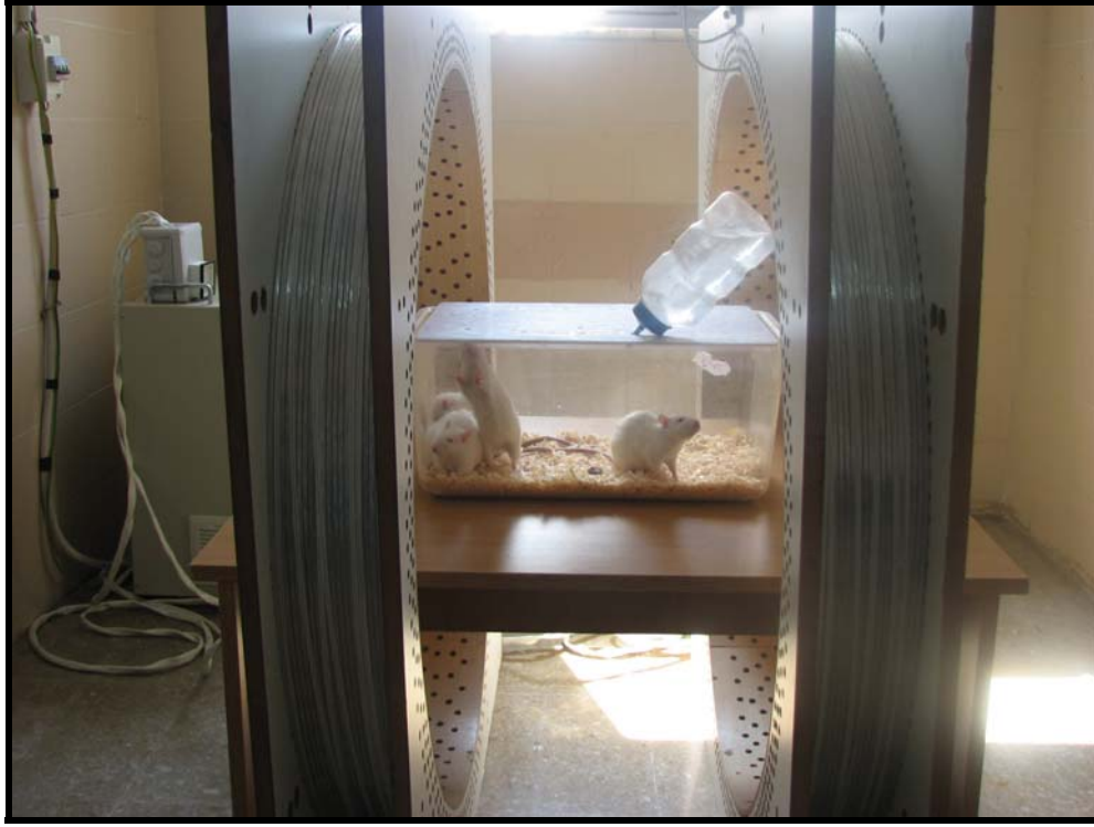
Şekil 5: Çalışmada kullanılan Helmholtz bobin sistemi.
