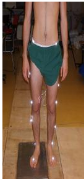
Şekil 3: Plug-in Gait modele göre marker yerleşimi
