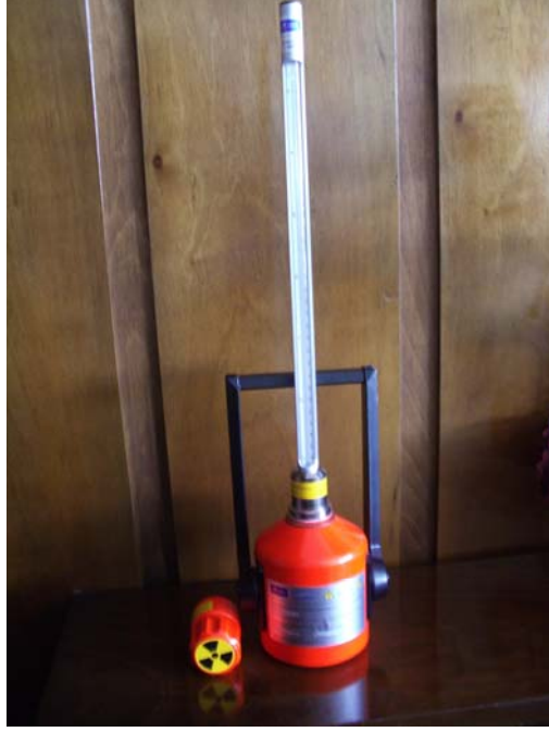
Şekil 15- Stronsiyum-90 Test Kaynağı İçinde Termometre ile Isı Ölçümü
