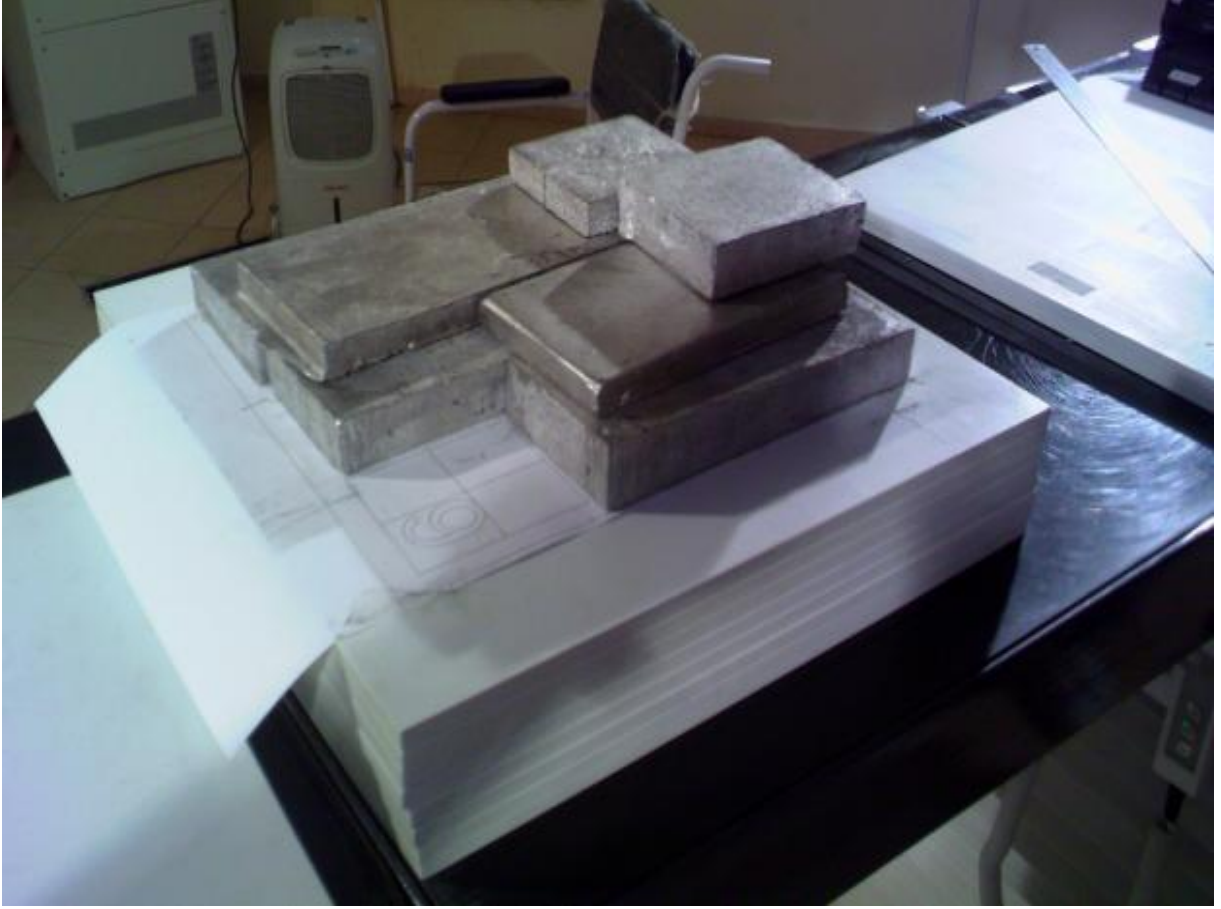
Şekil 3.13: Kalibrasyon filmi çekimi sırasında filmin ışınlanan alanı dışında kalan bölgeler korunmuştur.
