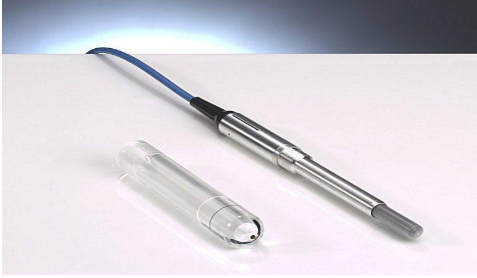
Şekil 3.7 : PTW Marka İyon Odası 14
