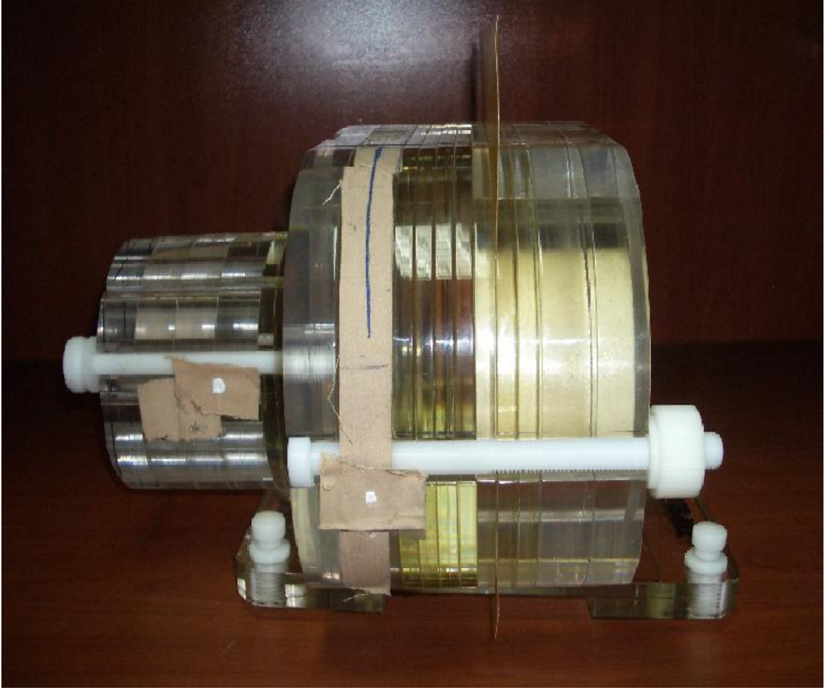
Şekil 3.14: Film dozimetresi için rando fantoma film şekilde görüldüğü gibi yerleştirilmiştir
