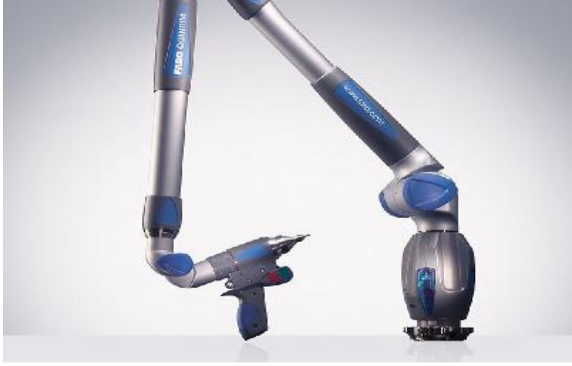
Şekil 7.1 Bir markanın özel olarak tasarladığı bir üç boyutlu ölçüm kolu.
