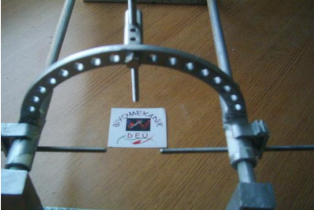
Şekil 5.2 X Ekseninde Kayma Hareketi Yapan Düzenegin, Her Üç Düzlemde Çalışan Temas Vidaları.
