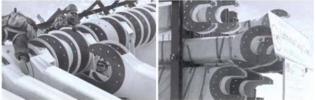
Şekil 3.119 Kanatların hareket diskleri (Valcarcel, 2011)
