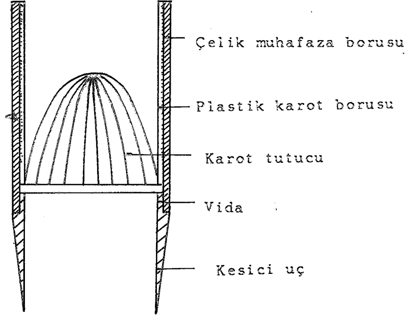
Şekil 3.2: Karot tutucunun (core catcher) ana hatları
